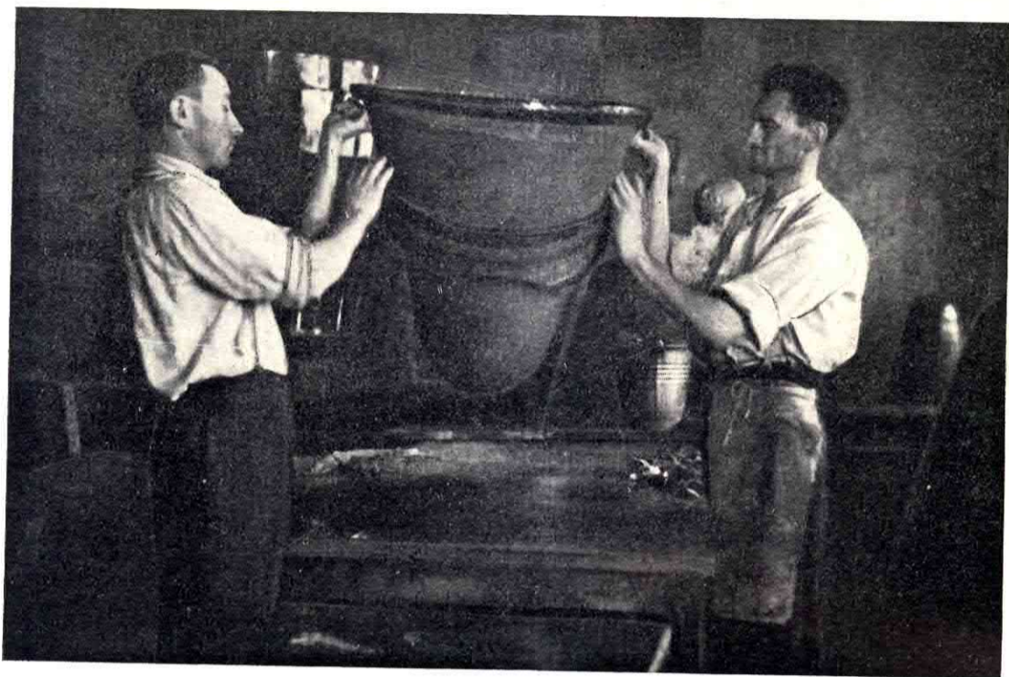
Imbastitura (Lavorazione alla campana) Il cono di pelo si stacca dalla matrice
